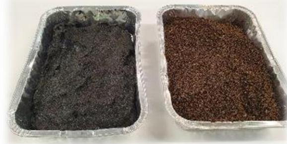
Figura 2. Fracción sólida del lodo de acuicultura marina (izq.) y producto biosecado (der.).
