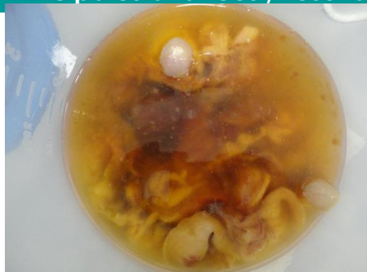
Fig. 1: Separación de aceite mediante decantación a partir de vísceras de trucha
