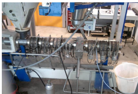
Fig 1: Extrudeur bi-vis Evolum HT53 (Clextal)
