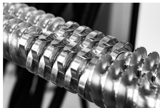
Fig 2: Exemple de profil de vis en extrusion
