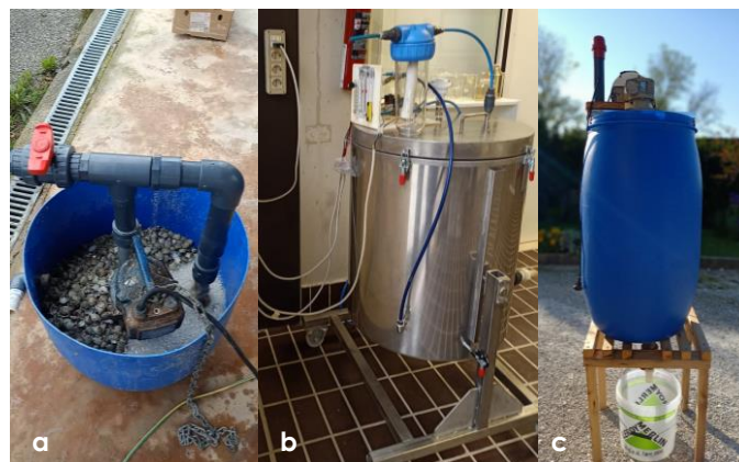
Fig 2: Triturazione (a), compostaggio (b) e idrolisi (c)
